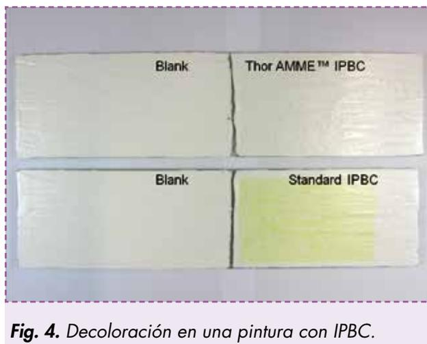
Fig. 4. Decoloración en una pintura con IPBC.
